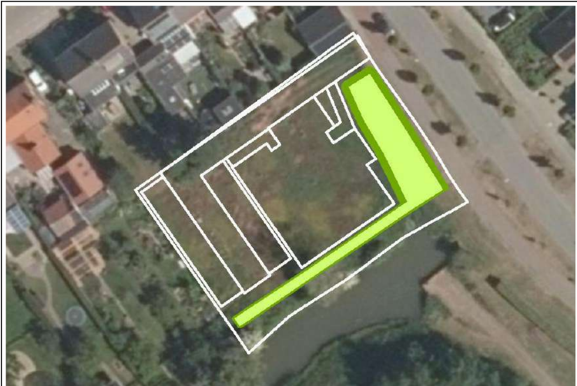
Figuur 16 - Overzicht hemelwatervoorziening. Licht groen: bodem, donkergroen is talud. (bron: rapportage Tauw)
