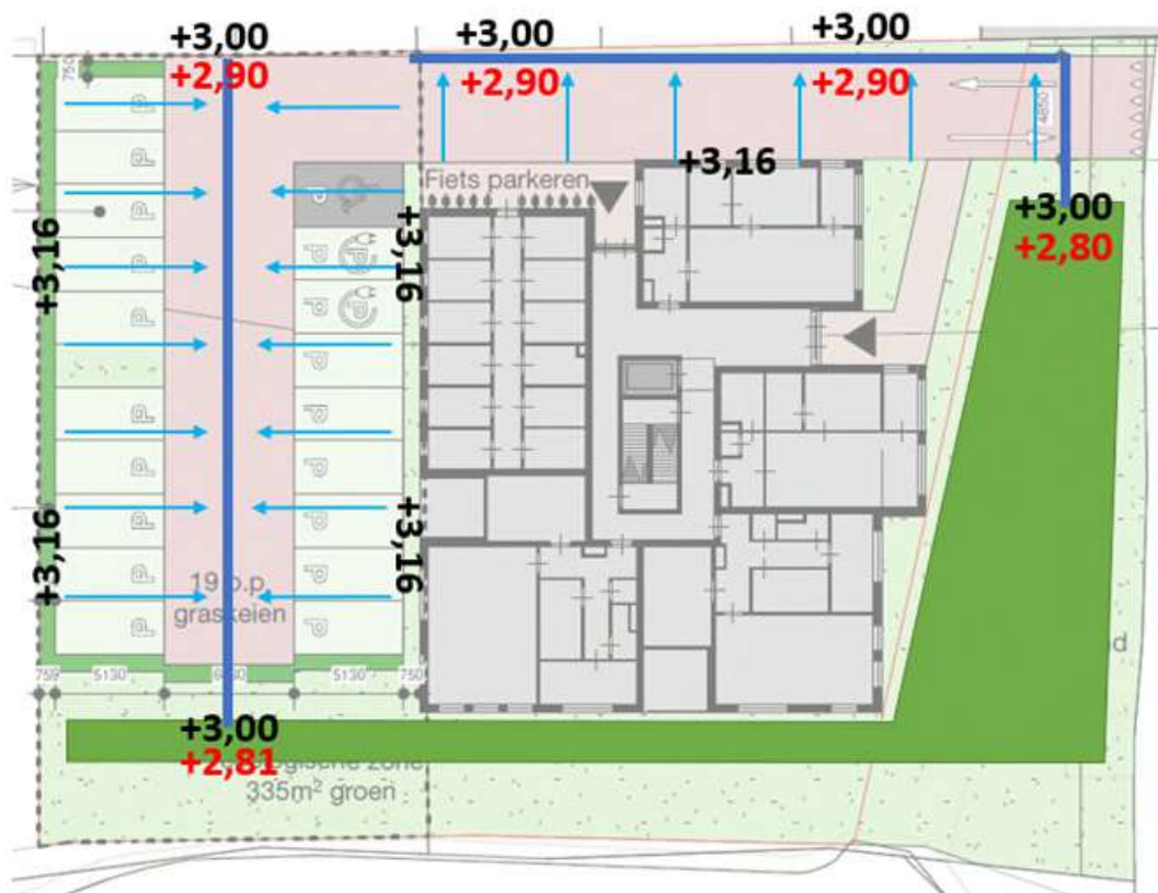
Figuur 4.2. Overzicht wateraanvoer. Donker blauwe lijn: roostergoot, licht blauwe pijlen: stroomrichting, zwarte getallen: maaiveld in mNAP, rode getallen: b.o.b. 1 in mNAP.
